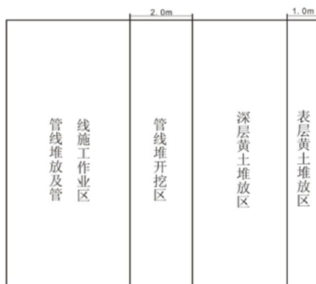
图 5.2.1-5 管道施工作业场地平面布置图
